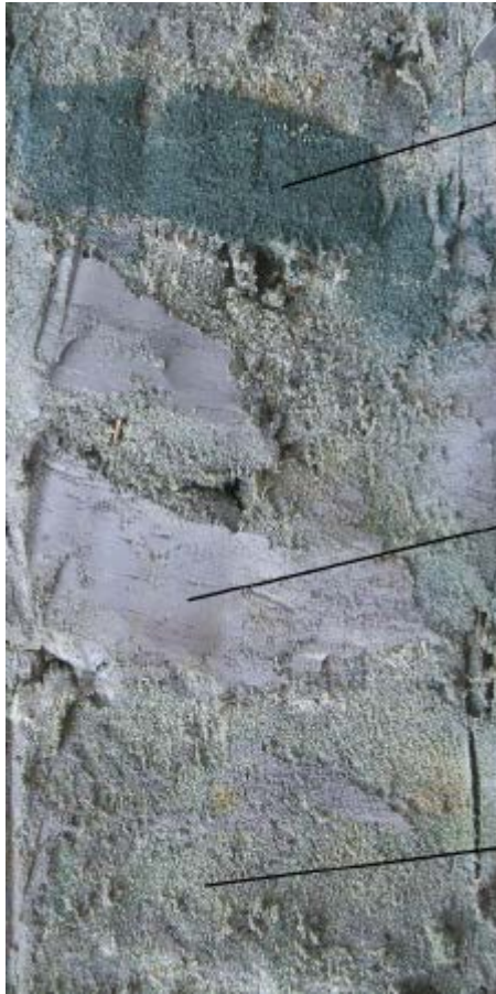
Figuur 8.3. Kernboring Dessel-2, diepte 32,03 m, kleivoorkomens, van boven groene klei rijk aan glauconiet-smectiet in de kleifraction, in het midden zalmkleurige klei rijker aan smectiet en kaoliniet, onderaan glauconietrijk kleiig zand met dezelfde kleien (Adriaens, 2015).
