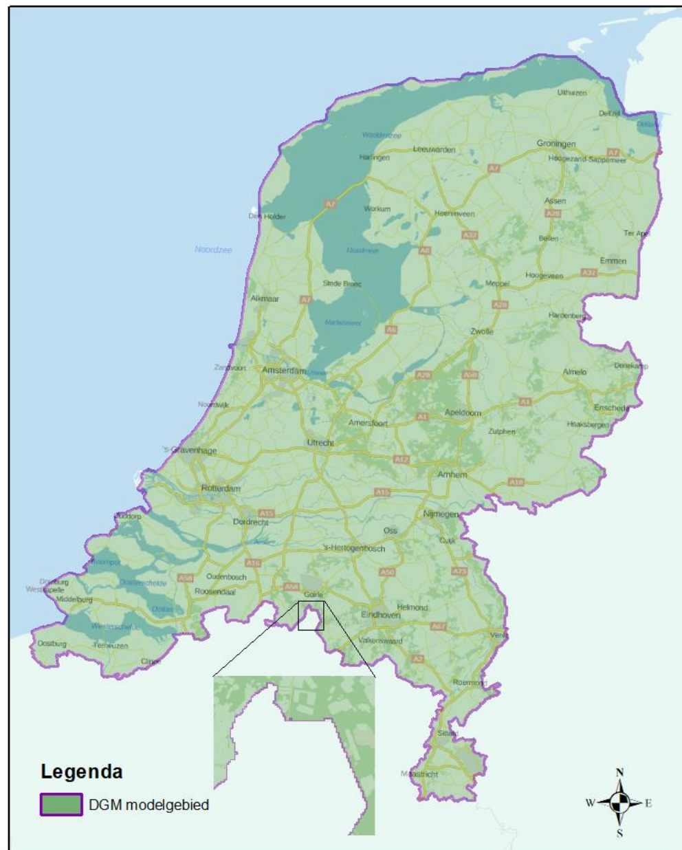
Figuur 2.3 Weergave van het landelijk modelgebied met een vergroting langs de landgrens waardoor zichtbaar is dat de modelgrens de rechte horizontale en verticale rastercel randen volgt.
