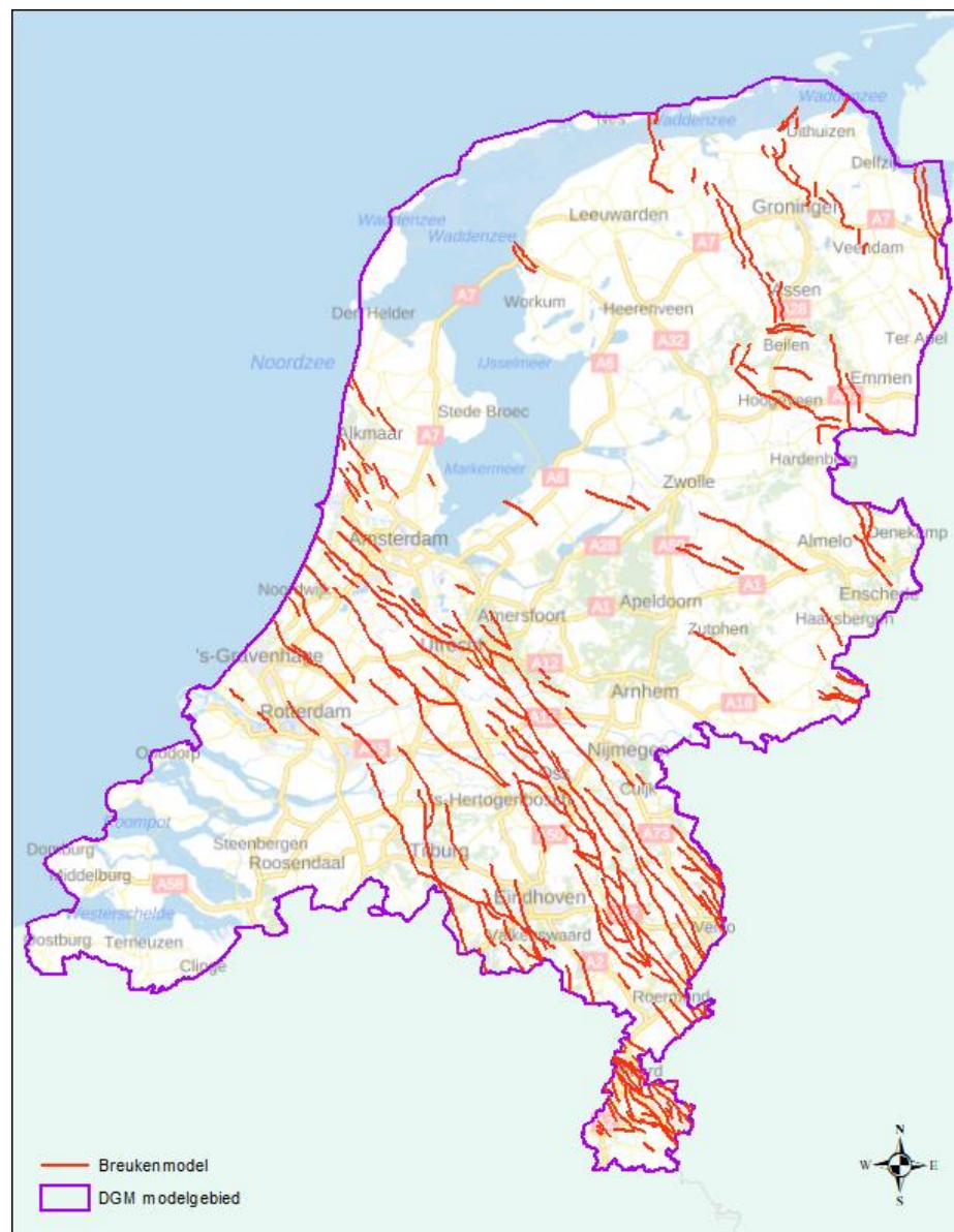
Figuur 4.3 Overzichtskartaal met de ligging van de breuken (breukenmodel versie 2.2 (2014)) in de ondiepe ondergrond van Nederland.
